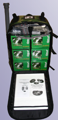
Ранцевые лаборатории НКВ-Р/м (малая) и НКВ-Р
