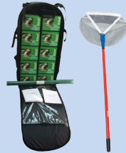
Ранцевая полевая лаборатория исследования водоёмов НКВ-Р с сачком гидробиологическим
