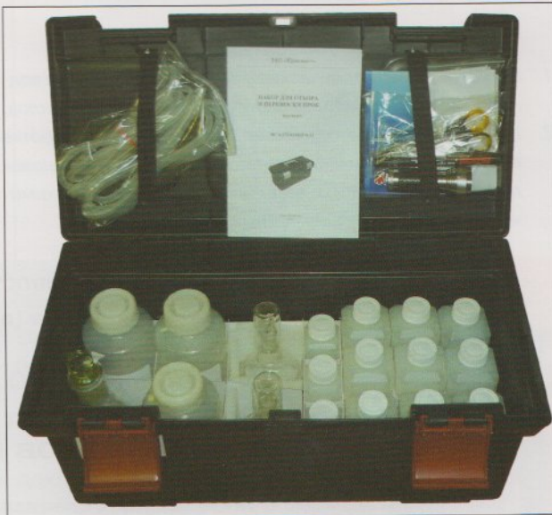
Рис. 3. Набор для переноски и хранения проб котловой воды.
