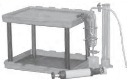
Предназначен для измерения объёма воздуха, прокачиваемого поршневыми и сильфонными аспираторами типов НП-3М, НП-4, АМ-5Е, GASTEC GV-100 и т. п., позволяющими прокачивать дозированный объём газовой среды от 50 до 100 см<sup>3</sup> за один цикл.
