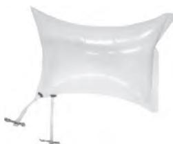
Предназначена для отбора проб с целью их кратковременного хранения и доставки к месту последующего анализа. Благодаря оснащению двумя штуцерами с зажимами, а также застёжкой-молнией, позволяет отбирать пробы из баллонов и газовых магистралей с избыточным давлением, а также непосредственно из воздуха при атмосферных условиях. Заполняется принудительно. Объём — не менее 10 л (в зависимости от наполненности), в упаковке 2 запасных пакета. Применяется согласно выбранной методике исследования проб.
