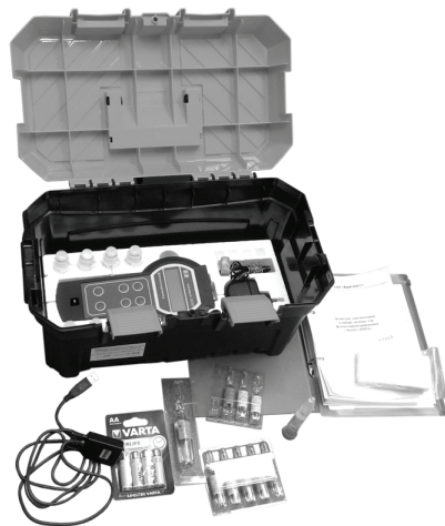
Рис. 2. Настольная почвенная лаборатория НПЛ и оборудование из её состава: a — укладка лаборатории; б — тест-комплекты; в цифровые весы, кондуктометр, почвенный термометр и пр.; г — сито почвенное; д — набор-укладка для фотоколориметрирования «Экотест-2020-К».
