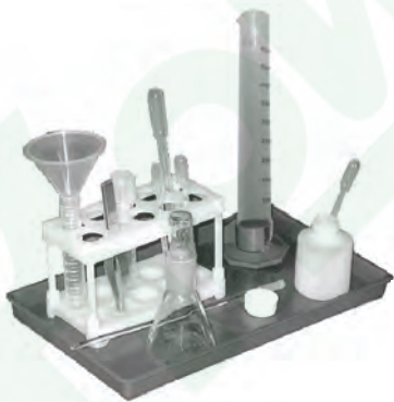
Рис. 5. Штатив с принадлежностями из состава экспресс-лаборатории СПЭЛ
