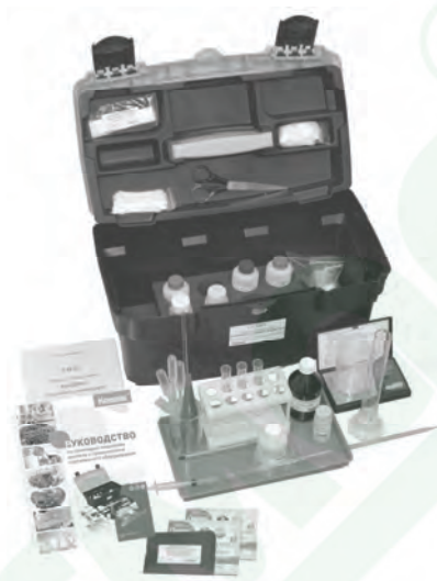
Рис. 1. Экспресс-лаборатория «Контроль столового инвентаря» в закрытом (а) и развёрнутом (б) видах
