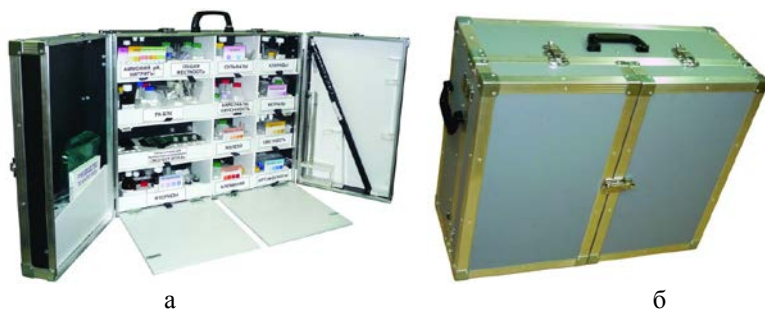
Рис. 3. Полевая лаборатория анализа воды НКВ-12 в развёрнутом (а) и закрытом (б) видах.
